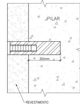
OBS.: SE O PILAR FOR EM CONCRETO APARENTE O PINO PODERÁ TER UM COMPRIMENTO DE 30mm.
